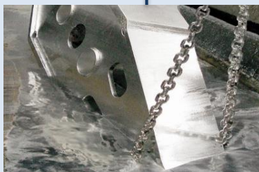
ZABEZPIECZENIE ANTYKOROZYJNE – MAŁOWANIE I CYNKOWANIE
